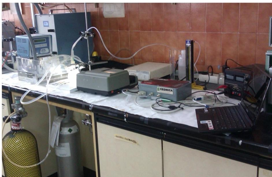
**Figura 8.** Fotografía del analizador de gases Infrarrojos (IRGA, Sensor de CO<sub>2</sub> modelo Li-820) en modo abierto.
