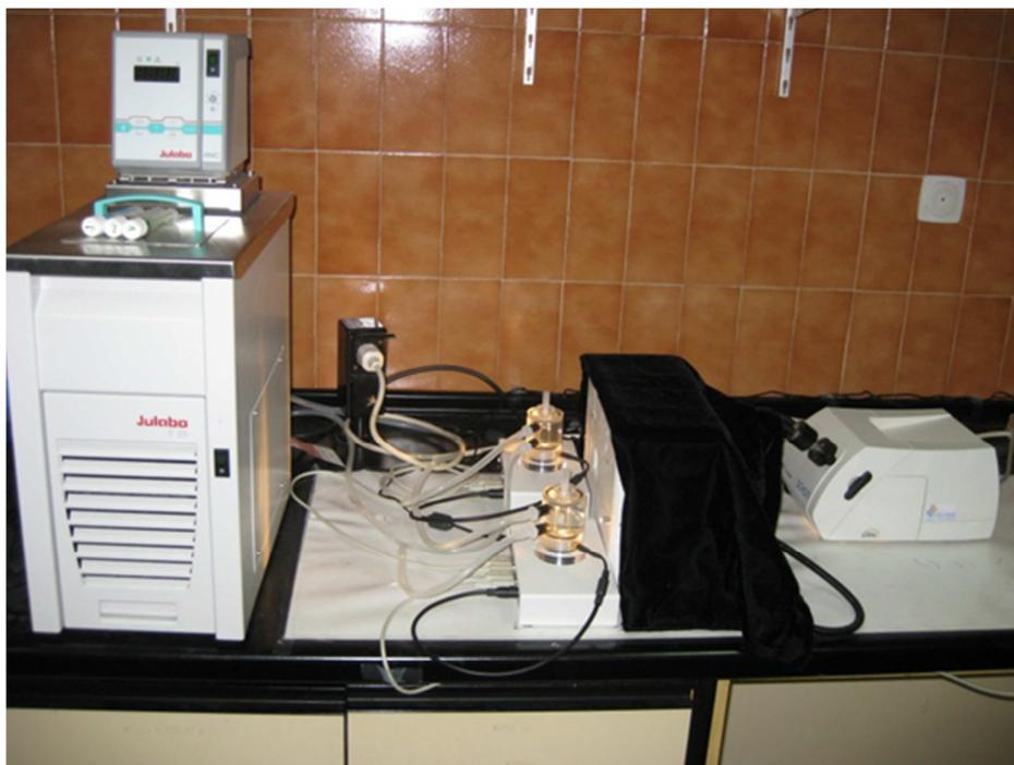
**Figura 7.** Fotografía del sistema para la medida de fotosíntesis como evolución de  $\text{O}_2$ .
