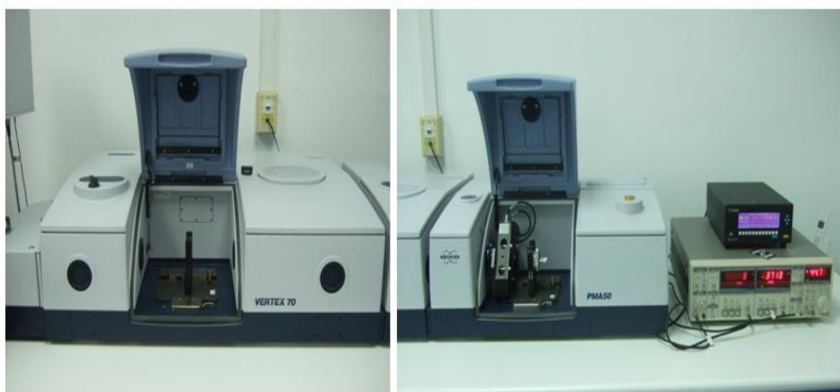
Figura 2.7. Espectrofotómetro FT-VCD acoplado al módulo PMA 50. A la derecha de la imagen se muestran el PEM y el LIA.
