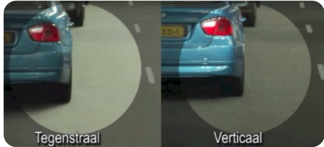
Figura 16. La iluminación a contraflujo garantiza un mayor contraste entre el vehículo y la carretera
