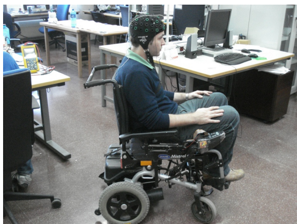
Figura 4: Prototipo de la silla de ruedas controlada por el sistema BCI
