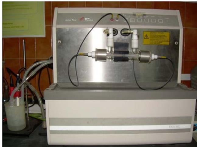
Figura 2.10. Fotografía del sistema de análisis electrocinético EKA (célula de flujo a través de los poros).
