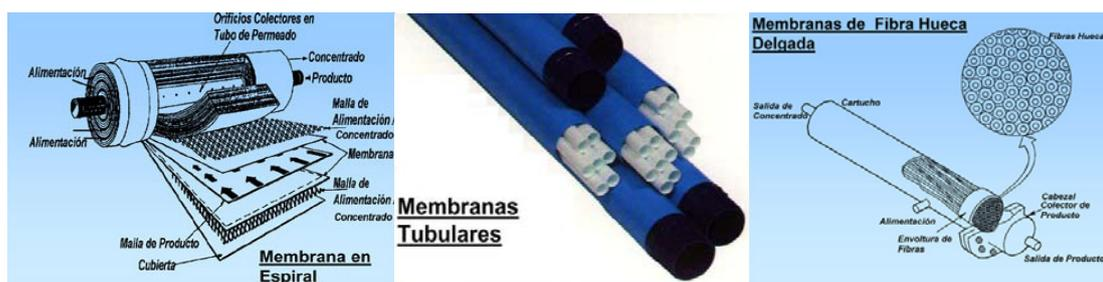
Figura 1.12. Distintas estructuras de las membranas: (a) Láminas en espiral; (b) Tubulares; (c) De fibra hueca [1].
