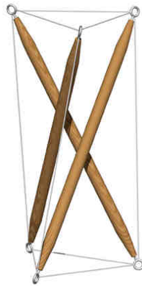
Figura 2.1. Ejemplo de estructura tensegrital
