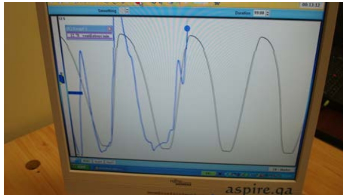
Figura 2. Patrón respiratorio a seguir por el atleta a través del módulo de respiración de Schufried Biofeedback 2000xpert. Tras un período de calibración, el software desarrolla el patrón ideal a seguir por cada atleta (línea negra). La línea azul representa una retroalimentación visual de la respiración del atleta en tiempo real. El objetivo es hacer que coincida con la línea-guía negra.
