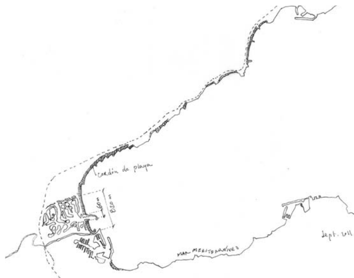
[Fig. 10] Bahía de Saint Trôpez. Representación de línea de costa y de la presencia de playas (rallado) en la actualidad. Obsérvese cómo la marina de Grimaud ocupa un frente de más de 800 metros de costa y sin embargo, la playa sólo se interrumpe durante los 60 m de anchura de la bocana. Fuente: elaboración propia. [Fig. 11] Vista aérea de Port Grimaud antes del comienzo de obras en 1966. Fuente: SPOERRY F., "A gentle Architecture", Pheon Books, 1991.
