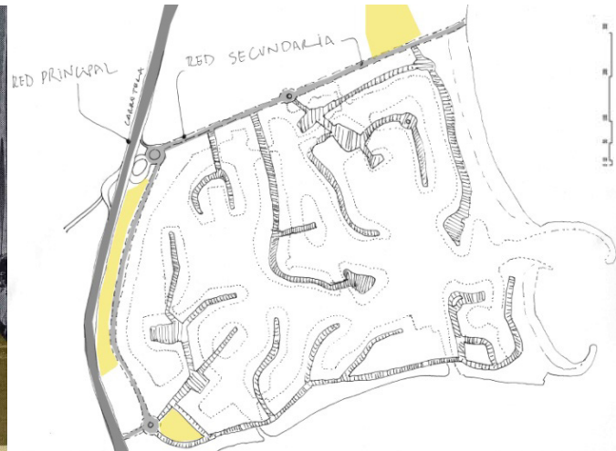
[Fig. 20] Fuente: Tratamiento de imagen, Revista Architecture Française nº 325 y 326. Sept-Oct 1969. Pp. 38. [Fig. 21] Croquis esquemático de funcionamiento de tráfico rodado y vías interiores. En amarillo, superficies de aparcamiento exteriores. En gris oscuro, autovía, en gris claro, carreteras que rodean la marina, y ralladas las calles interiores y privadas dentro del complejo, preferentemente peatonales. Fuente: elaboración propia.
