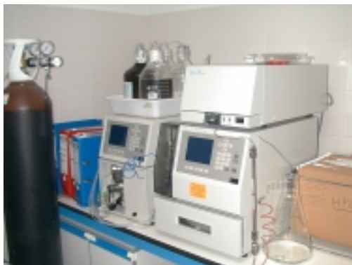
Figura M.12. Equipo de HPLC empleado con todos sus componentes.
