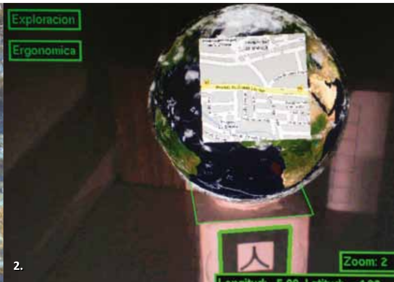
Sobre estas líneas, dos ejemplos de aplicaciones desarrolladas por el grupo ISIS de la UMA: 1. Suelo interactivo, mediante proyección de una lámina líquida que reacciona al movimiento como si se tratase de agua de verdad. 2. Aplicación de Realidad Aumentada para acceder a Google Earth mediante una pelota y un puntero láser.
