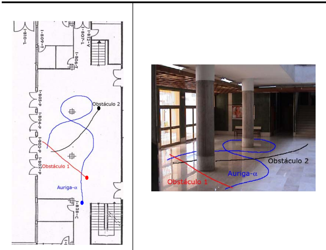
Figura 4.17. Caminos geométricos de Auriga- \alpha y los obstáculos móviles para el Experimento 2
