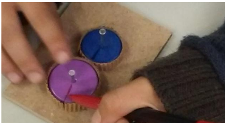
Figura 36 - Realização de um traço na horizontal em cada uma das rodas dentadas.
