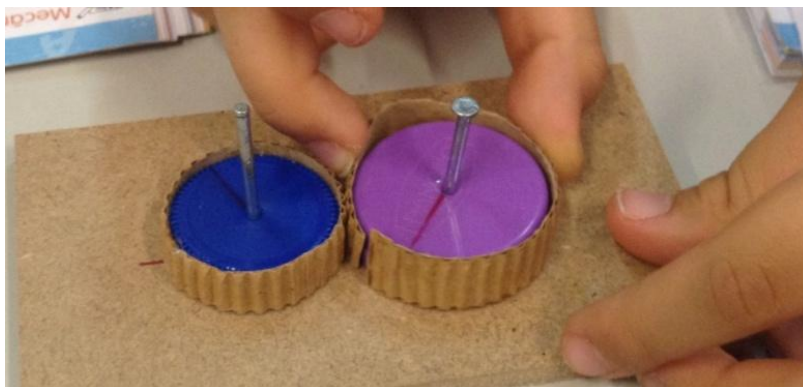
Figura 37 - Contagem do número de voltas que cada roda dentada dá, quando se faz rodar a engrenagem.
