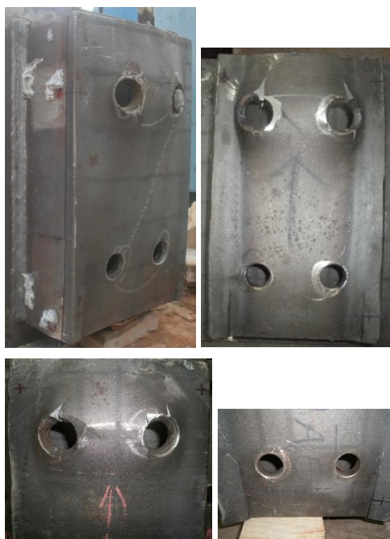
Fig. 14 - Deformações ocorridas nos ensaios experimentais.
