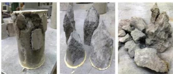
Fig. 2 - Modos de rotura do betão de 650 kg/m<sup>3</sup> de densidade para 20°C, 450°C e 650°C, Mydina e Wang (2012).
