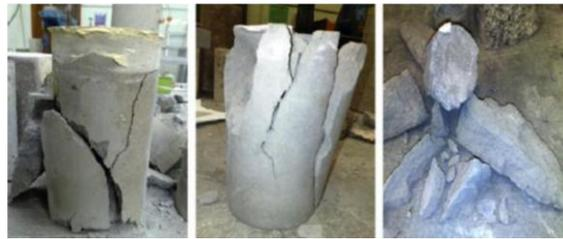
Fig. 3 - Modos de rotura do betão de 1000 kg/m<sup>3</sup> de densidade para 20°C, 450°C e 650°C, Mydina e Wang (2012).
