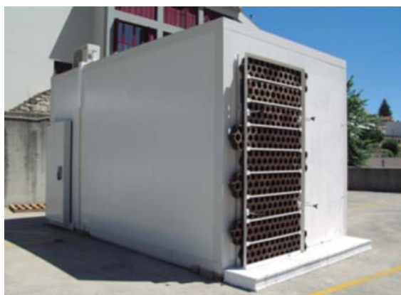
Fig. 9: Ensaio em clima real do sistema GEOGREEN sem vegetação (UBI, Covilhã, Portugal)
