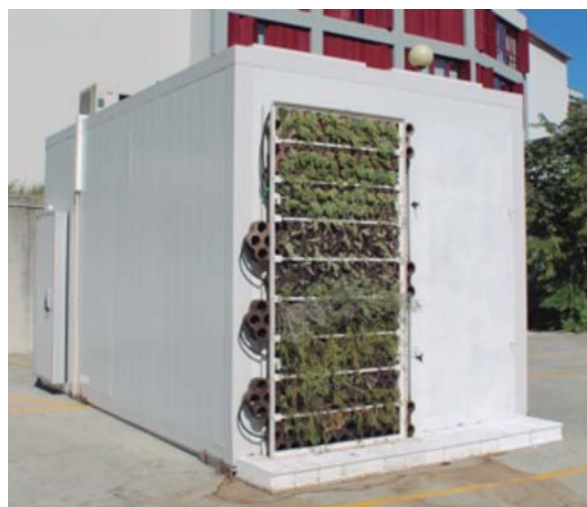
Fig. 10: Ensaio em clima real do sistema GEOGREEN com vegetação (UBI, Covilhã, Portugal)
