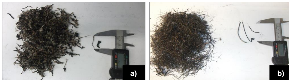
Figura 1: Fibras recicladas de pneu. a) Fibras têxteis. b) Fibras de aço
