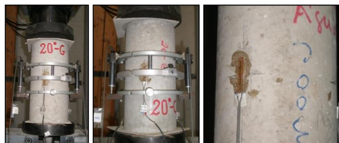
Figura 9: Módulo de elasticidade residual - sistema de ensaio
