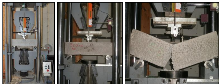
Figura 8: Resistência residual à flexão - sistema de ensaio
