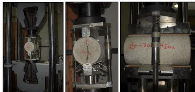
Figura 7: Resistência residual à tração por compressão diametral - sistema de ensaio
