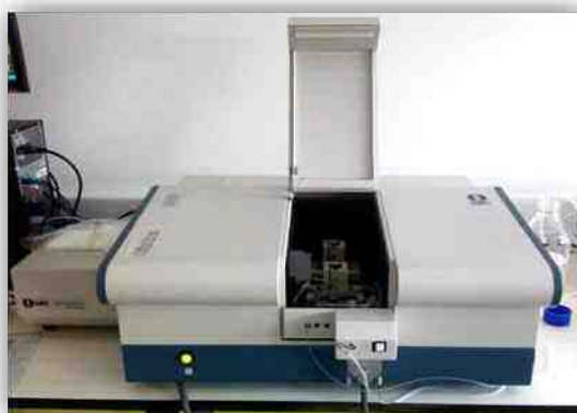
Figura 11 - Espectrofotómetro UV-Visível, utilizado para a determinação dos fenóis totais.
