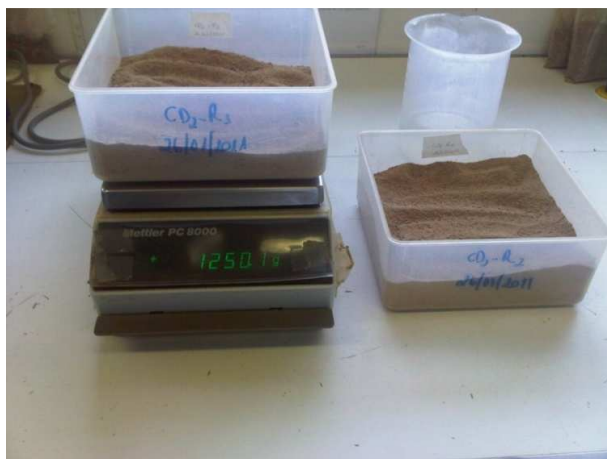
Figura 5 - Pesagem da amostra até à capacidade de campo
