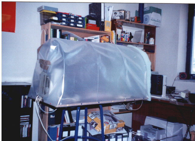
Figura 7.1 – Fotografia da estufa utilizada durante os testes da rede CAN.
