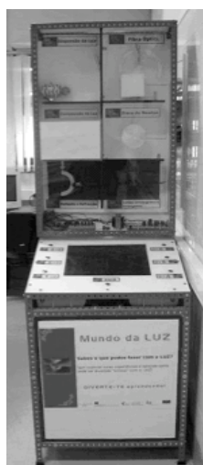
Fig. 11. Aspecto final do módulo expositivo e interativo. É visível a secção superior, com seis experiências; O monitor e o conjunto de botões de controlo ficam na zona central. O PC, as colunas de som e as fontes de alimentação ficam resguardados na zona inferior.
