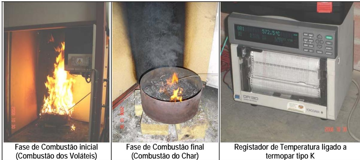
Figura 5 - Ensaios de combustão de biomassa arbustiva no LNEC/LERF
