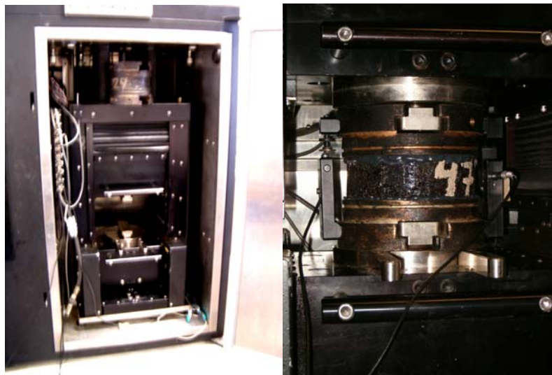
Figura 4.27 - Equipamento para a realização do ensaio de corte a altura constante do Laboratório de Engenharia Civil da UM
