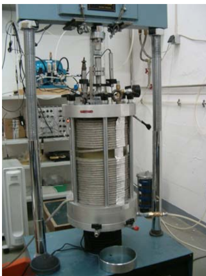
Figura 3.4 - Equipamento para a realização de ensaios de compressão triaxial existente no Laboratório de Pavimentos do DEC-FCTUC
