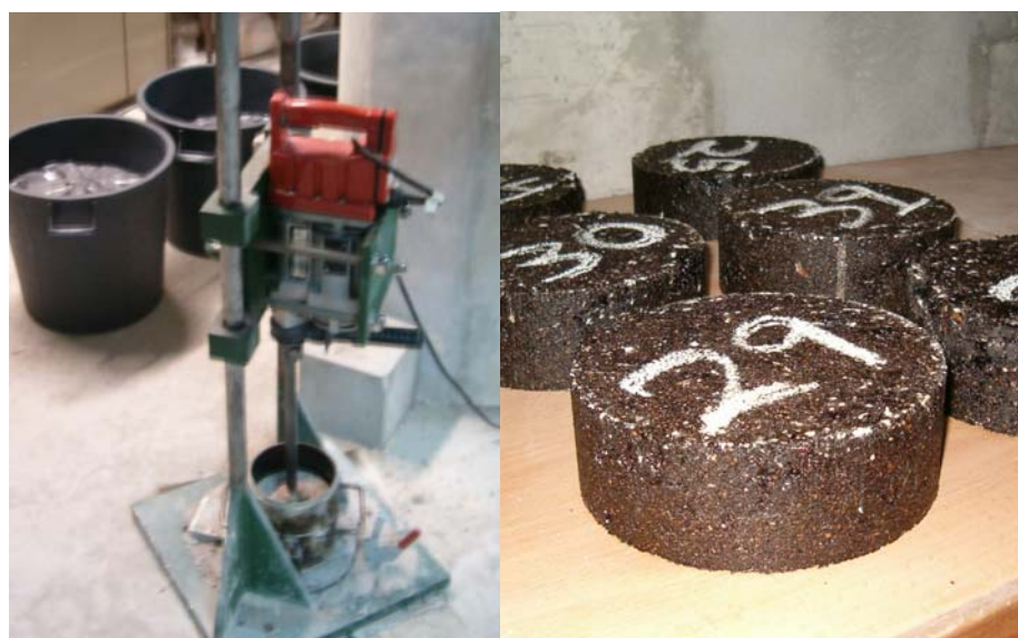
Figura 4.23 - Compactação e aspecto dos provetes da série VA para o ensaio de corte a altura constante
