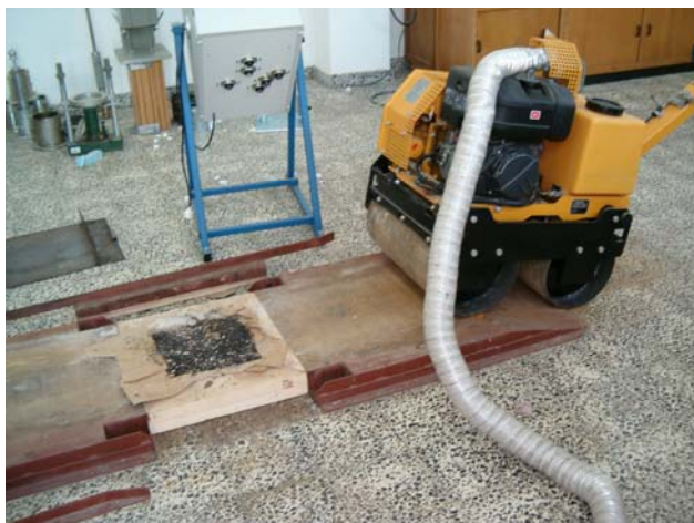
Figura 4.4 - Compactação dos provetes laje em laboratório para o ensaio de wheel tracking
