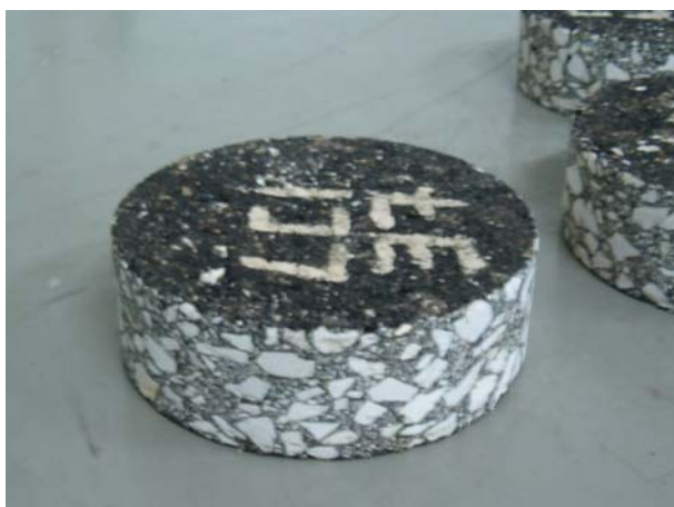
Figura 4.21 - Provetes da série LC para o ensaio de corte a altura constante
