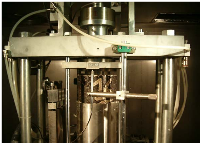
Figura 4.15 - Equipamento para a realização do ensaio de compressão uniaxial cíclico
