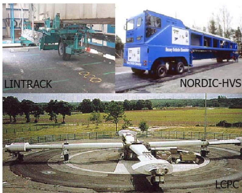
Figura 3.13 - Exemplo de simuladores de pista (pode observar-se o Lintrack T. U. Delft, o Nordic-HVS e a pista de ensaios do LCPC)
