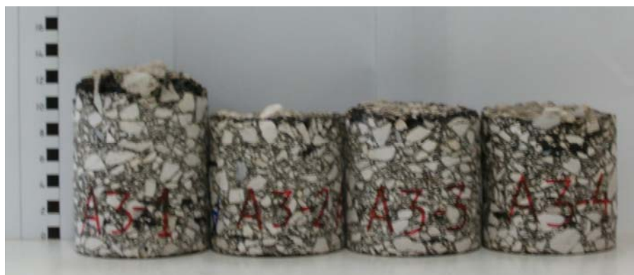
Figura 4.12 - Provetes de obra do troço A-3 ( P_b = 4,7\% ) para o ensaio de compressão uniaxial cíclico antes do corte e rectificação
