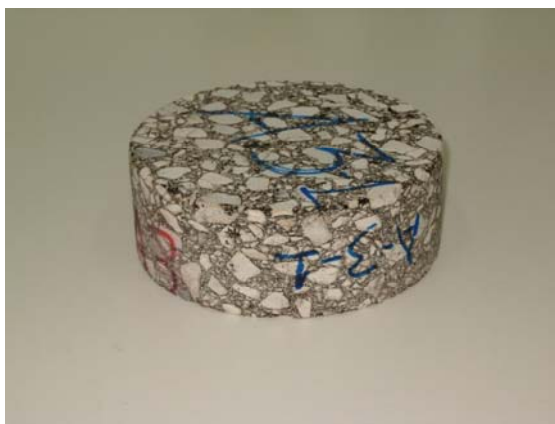
Figura 4.24 - Provede recolhido em obra para o ensaio de corte a altura constante
