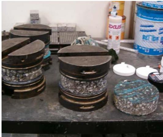
Figura 4.25 - Colagem do provete às placas de aplicação da carga
