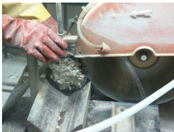
Figura 4.13 - Corte da face inferior dos provetes para o ensaio de compressão uniaxial cíclico
