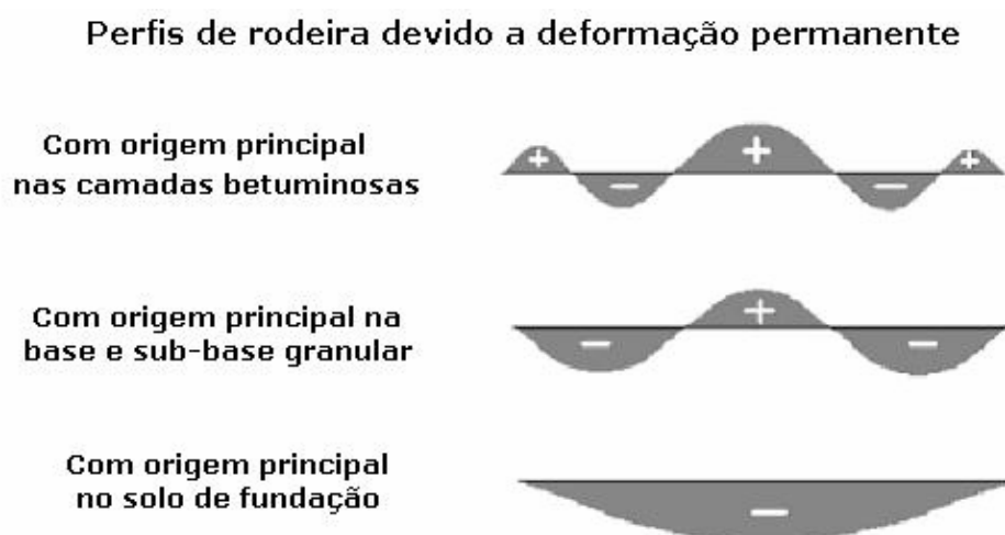
Figura 2.2 - Diferentes perfis transversais de rodeira associados à deformação permanente com origem em diferentes camadas (Fang et al. , 2004)
