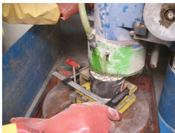
Figura 4.9 - Rectificação dos provetes para o ensaio de compressão uniaxial cíclico
