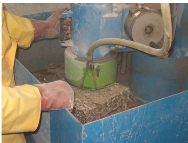
Figura 4.6 - Rectificação das faces dos provetes laje de obra para o ensaio de wheel tracking
