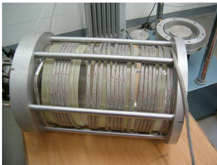
Figura 4.19 - Colocação de uma resistência eléctrica envolvendo a câmara triaxial para controlo da temperatura de ensaio
