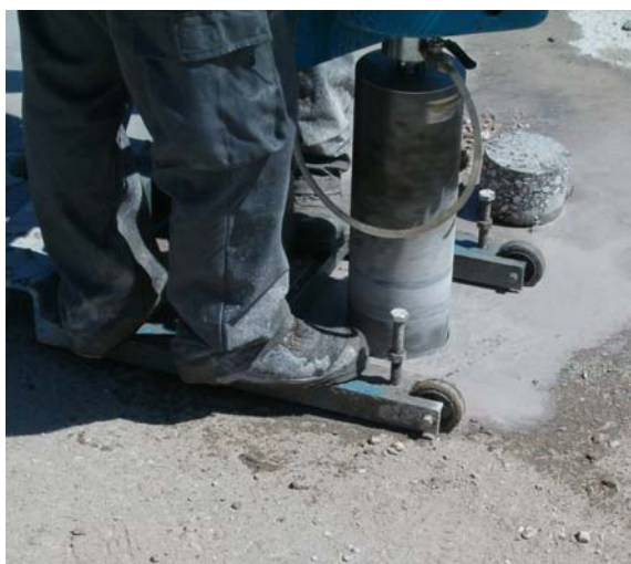
Figura 4.10 - Carotagem dos provetes de obra para o ensaio de compressão uniaxial cíclico
