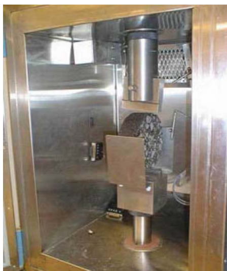
Figura 3.5 - Equipamento para realização de ensaios de tracção indirecta em misturas betuminosas (fabricante Instron Corporation)
