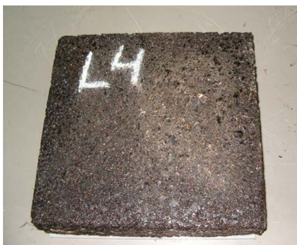
Figura 4.5 - Provede fabricado em laboratório em forma de laje com 305*305*80 mm para o ensaio de wheel tracking
