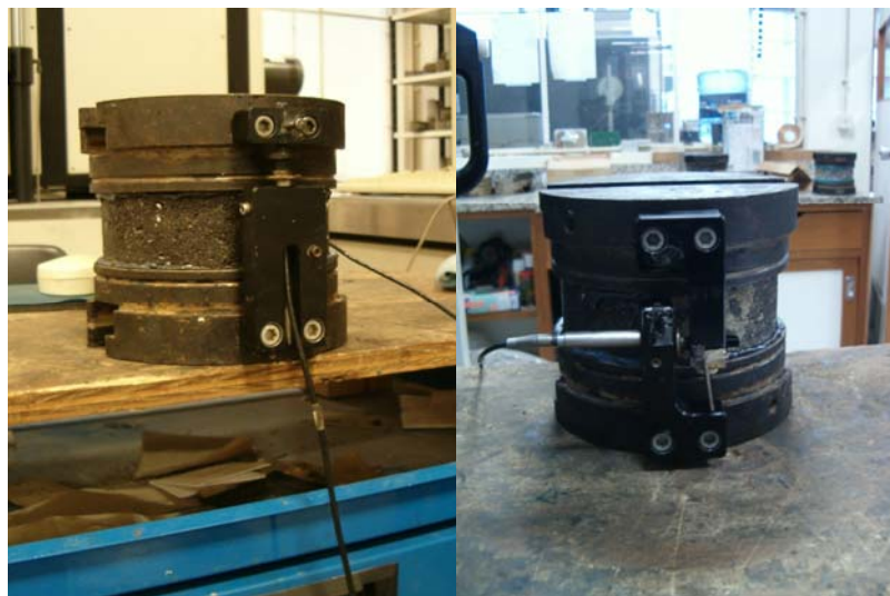
Figura 4.26 - Colocação dos LVDT's para o ensaio de corte a altura constante
