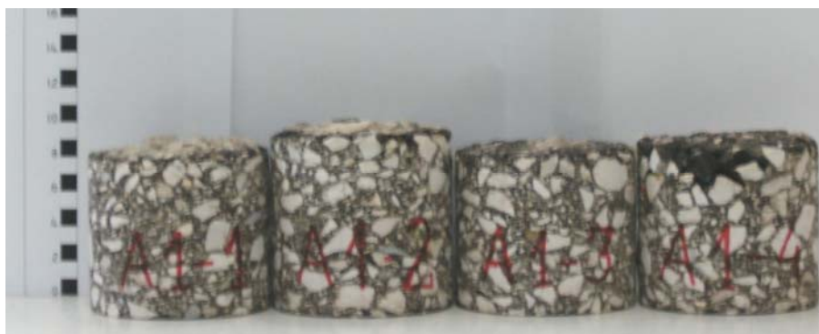
Figura 4.11- Provetes de obra do troço A-1 ( P_b = 3,7\% ) para o ensaio de compressão uniaxial cíclico antes do corte e rectificação
