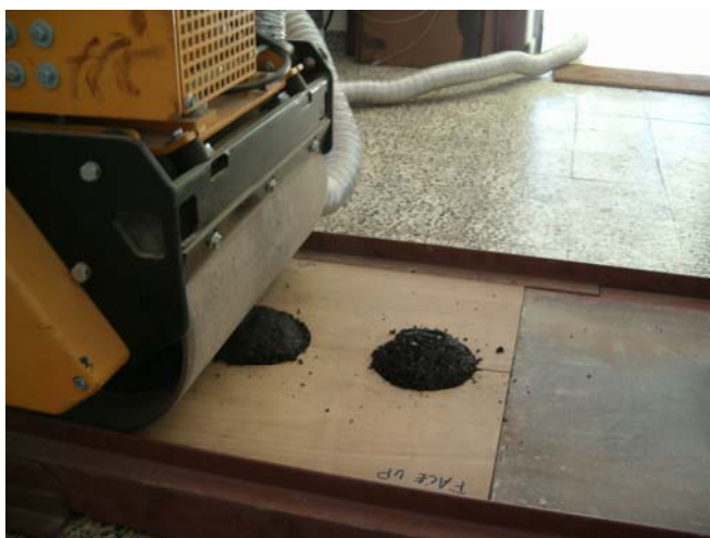
Figura 4.22 - Compactação de provetes da série PC para o ensaio de corte a altura constante
