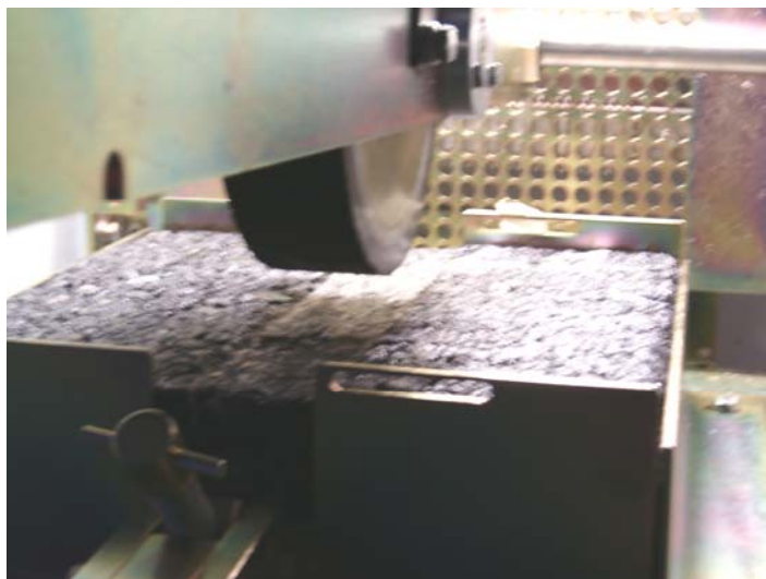
Figura 4.7 - Provete laje após realização do ensaio de wheel tracking
