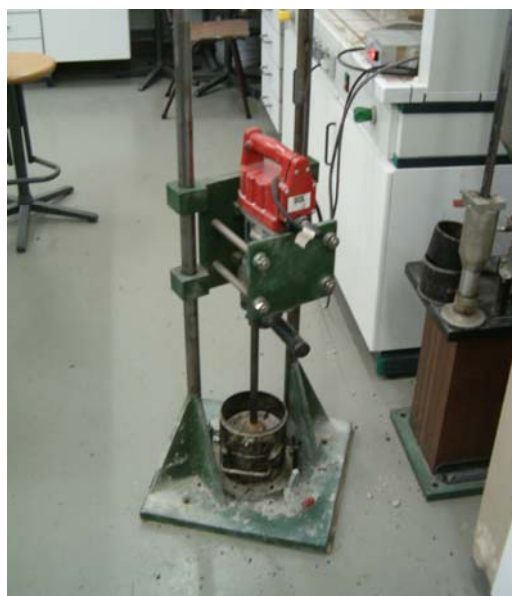
Figura 4.8 - Compactação em laboratório dos provetes para o ensaio de compressão uniaxial cíclico utilizando um equipamento de vibro-compactação tipo Kango
