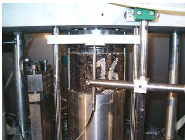
Figura 3.2 - Ensaio de compressão uniaxial cíclico realizado no Laboratório de Pavimentos do DEC-FCTUC.
