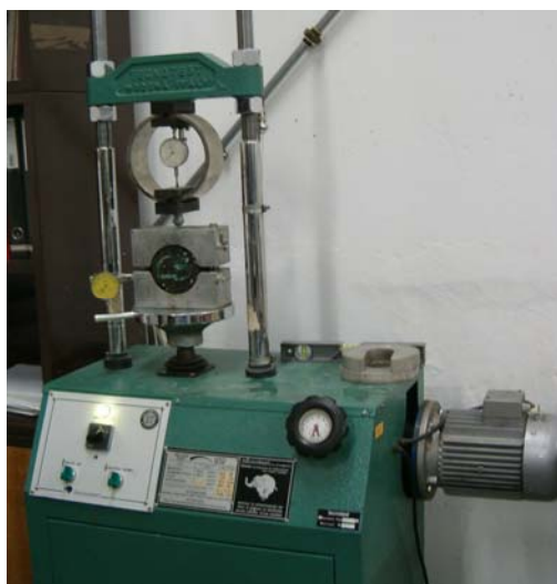
Figura 3.1 - Equipamento para o ensaio de Marshall existente no Laboratório de pavimentos do DEC-FCTUC
