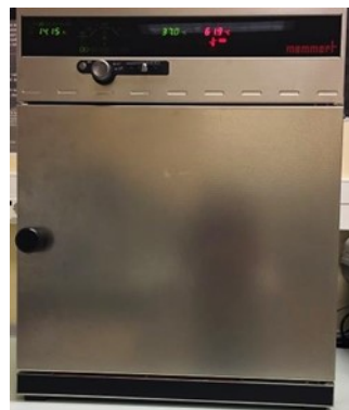
Figura 26 - Estufa de incubação (Memmert INE 400, Schwabach, Alemanha).
