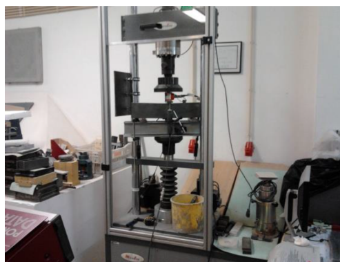
Figura 3.13 - Ensaio de determinação da energia de fractura
