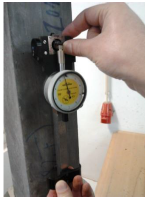
Figura 3.11 - Ensaio de determinação do módulo de elasticidade em compressão
