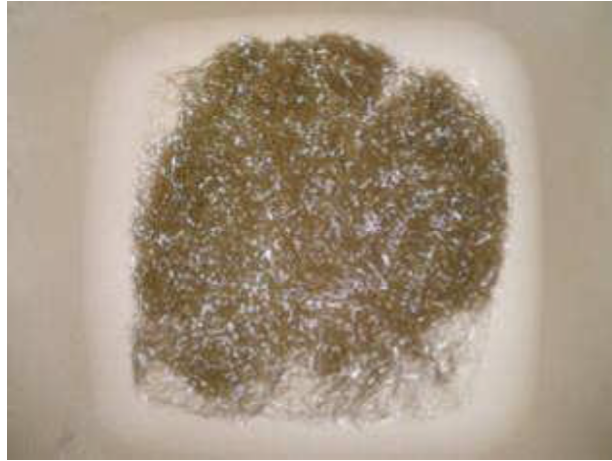
Figura 3.2 – Micro-fibras 0,12/10mm da Dramix®.
