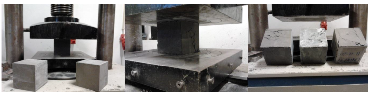
Figura 3.14 – Ensaio de compressão em cubos
