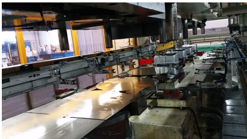
Figura 54 – Etapas de conformação para um cárter de motor (Kirchhoff Automotive Portugal)
