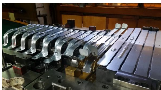
Figura 59 – ESQ: Reforço (esquerdo e direito) estrutural de um veículo produzido por uma ferramenta progressiva composta. (Kirchhoff Automotive Portugal)
