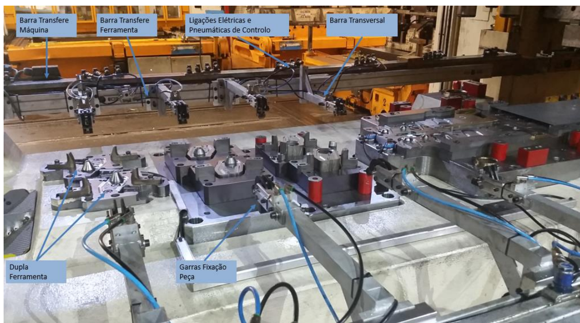
Figura 55 – Ferramenta Transfere para estampagem duas peças em simultâneo (Kirchhoff Automotive Portugal)
