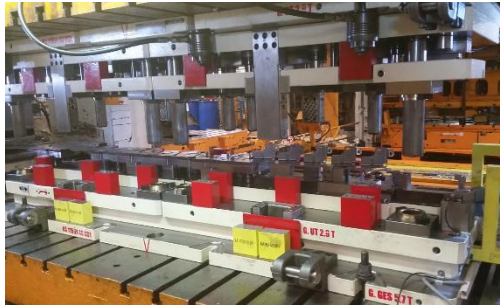
Figura 68 - Ferramenta montada na prensa durante ensaio dinâmico (Kirchhoff Automotive Portugal)
