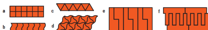
Figura 39 – Exemplo de Layout de bandas favoráveis á poupança de matéria-prima (Schuler GmbH)
