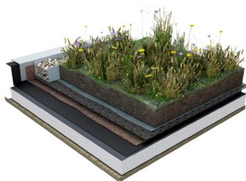
Figura 15 – Esquema de montagem de uma Cobertura Verde.
