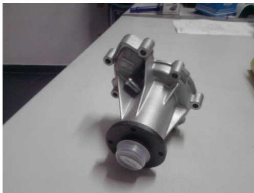
Fig. A.17 Bomba de água
