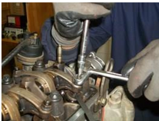
Fig. A.7 Afinação das válvulas
