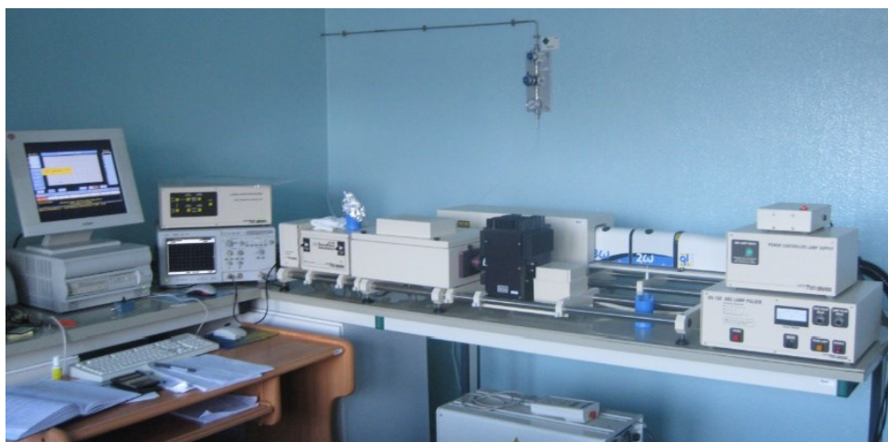
Figura 2.1 – Sistema de Laser Flash Photolysis utilizado para a realização das experiências.
