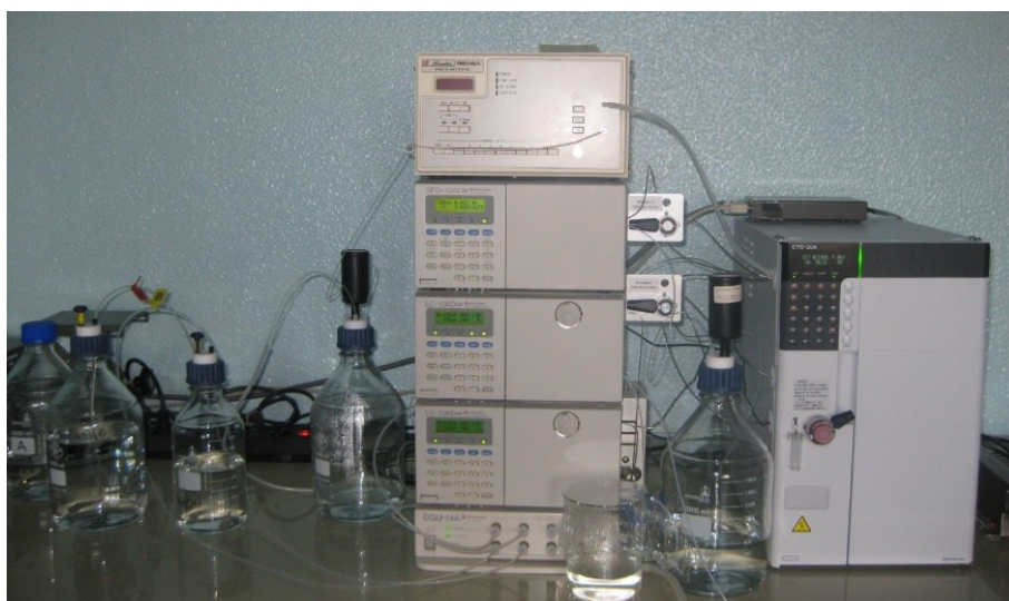
Figura 2.2 – Sistema de HPLC analítico utilizado na análise quantitativa dos fotoprodutos maioritários das soluções fotolisadas.
