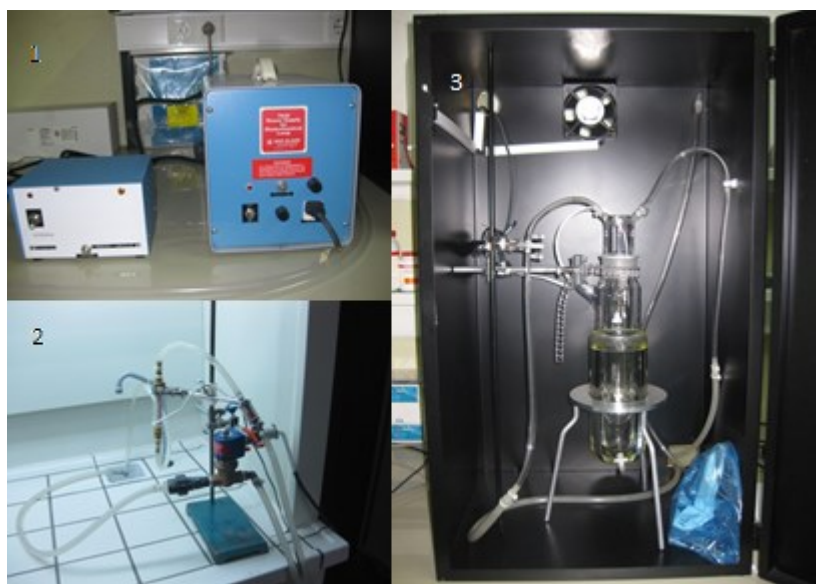
Figura 2.3 – 1) Fonte de energia do reactor fotoquímico; 2) Sistema de arrefecimento da lâmpada e válvula cutoff do sistema; 3) Reactor fotoquímico.
