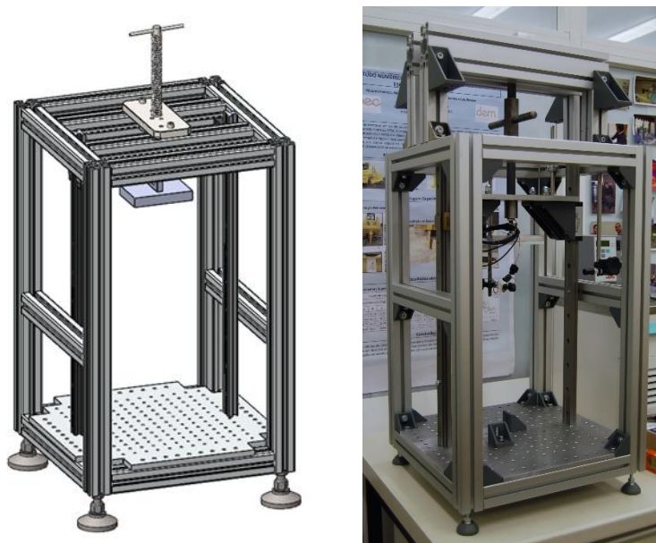
Figura 3.13 - Bastidor desenvolvido para os ensaios mecânicos.
