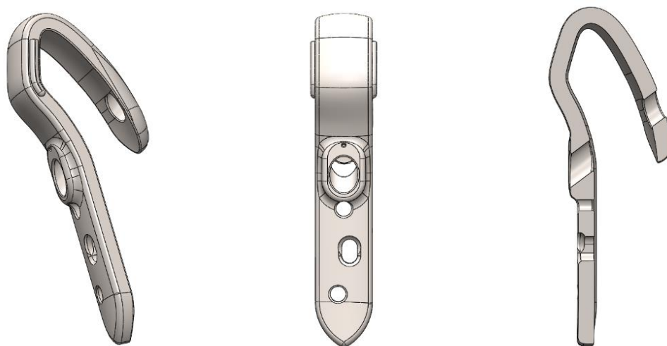
Figura 4.12 - TPC com modificação no escatel e no 2º furo da diáfise.
