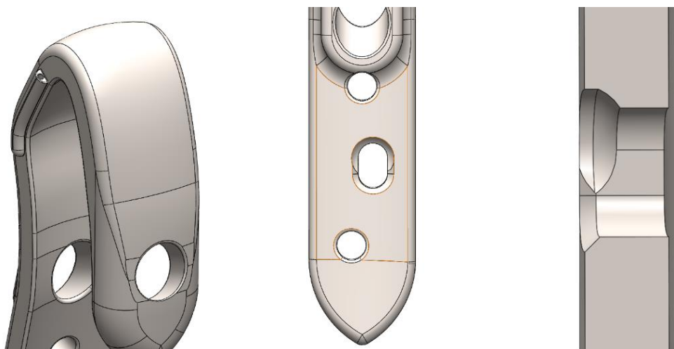
Figura 4.13 - Pormenor do escatel com furo para fixação do instrumental, e pormenor do furo para compressão.
