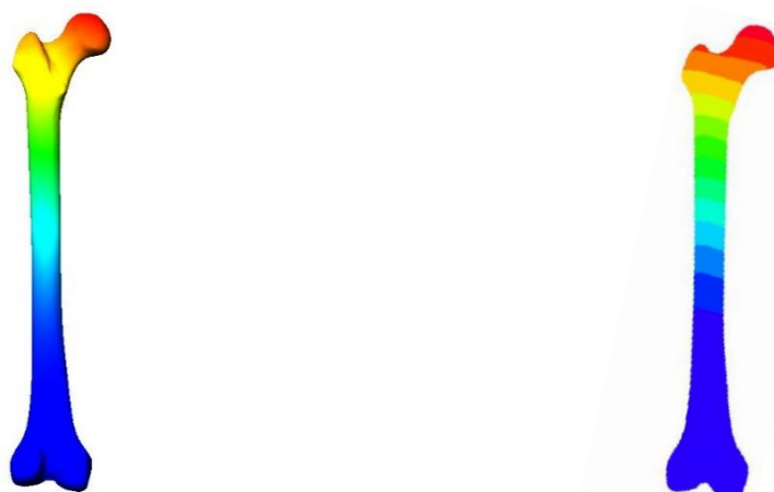
Figura 3.7 – Deslocamentos globais ( Solidworks (esq.) e ADINA (dir.)).
