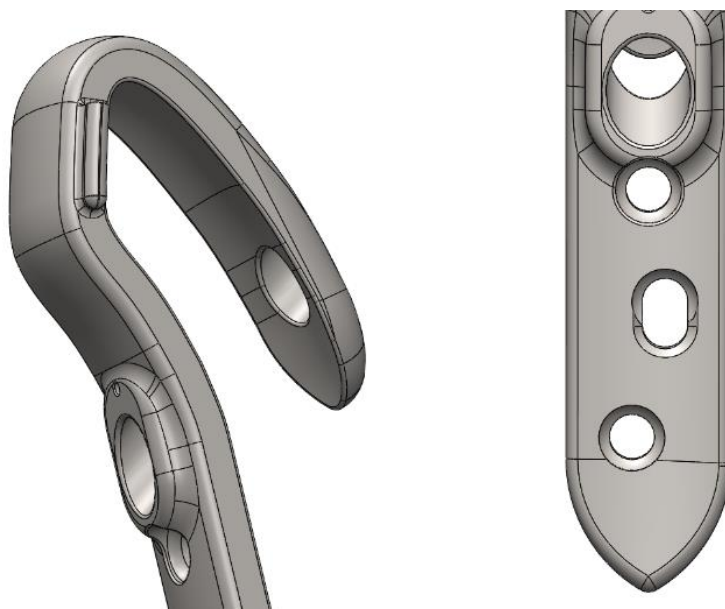
Figura 4.15 - Pormenor das alterações realizadas nos escatéis de fixação e nos furos na placa.
