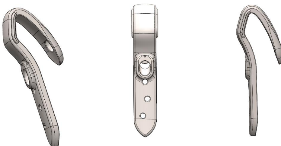
Figura 4.11 - TPC com alteração na zona do furo e escatel para instrumental cirúrgico.
