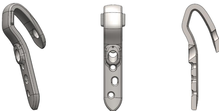
Figura 4.14 - TPC com escatéis e furação otimizados.
