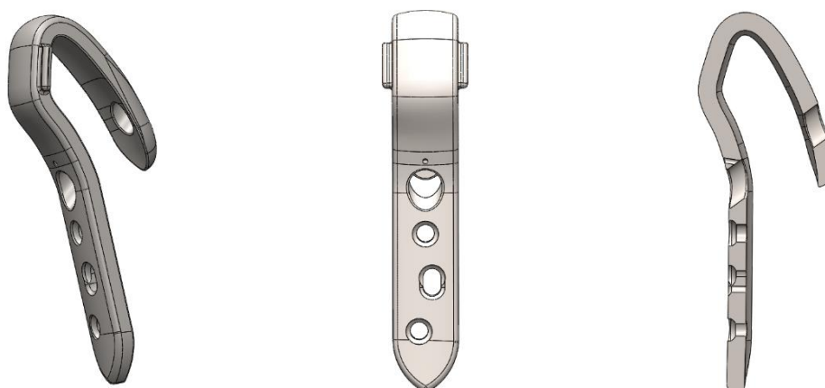
Figura 4.17 – TPC com escatéis e furação otimizados mas sem reforço.
