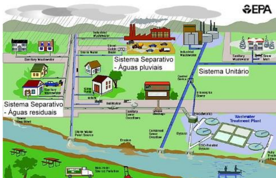
Figura 2.3 Esquema exemplificativo de sistema unitário e sistema separativo (EPA, 2014)
