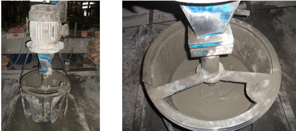
Figura 3.5 – Misturadora de argamassa
