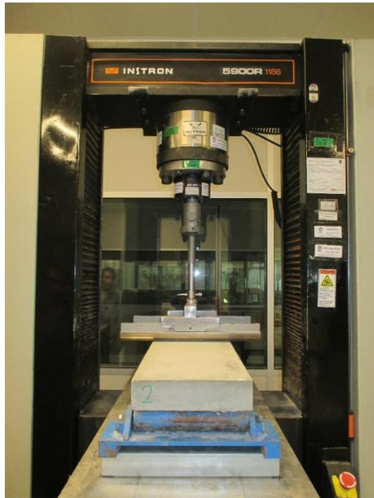
Figura 5.19 – Nervura do tipo R preparado para ser ensaiado
