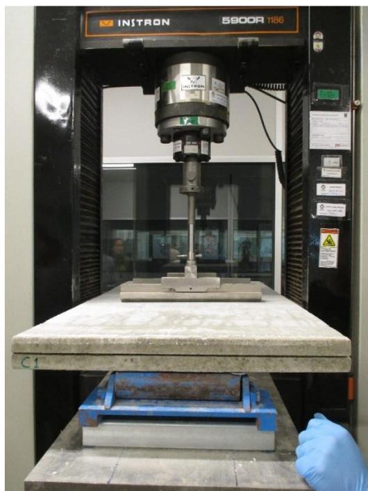
Figura 5.20 – Nervura do tipo C preparado para ser ensaiado
