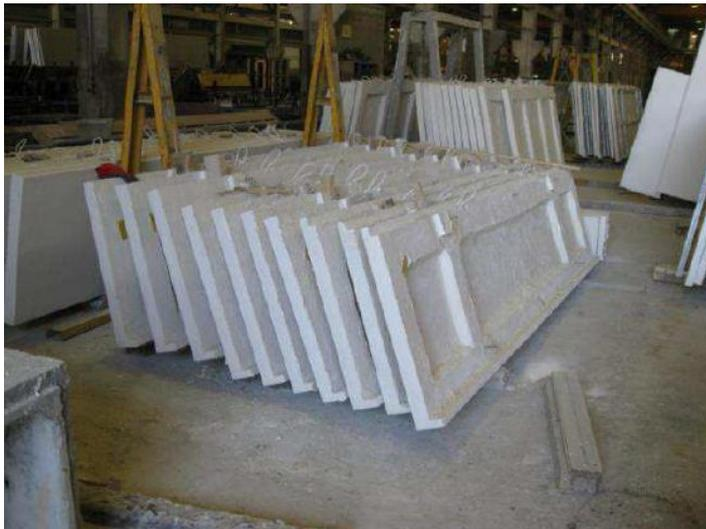
Figura 3.1 – Exemplo de painel do tipo nervurado
