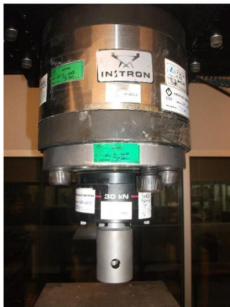
Figura 5.17 – Célula de carga de 30kN
