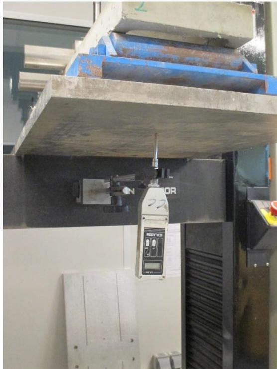
Figura 5.23 – Posição do defletómetro para medição dos deslocamentos verticais das nervuras
