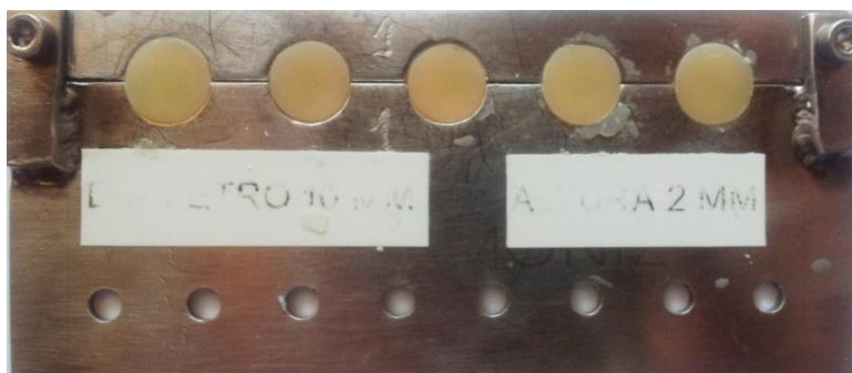
Figura 4 - Molde metálico de 10 mm de diâmetro e 2 mm de altura preenchida com resina composta após esta ter sido polimerizada
