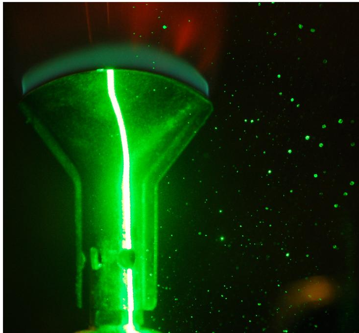
Figura 2.6: Imagem de um ensaio de PIV
