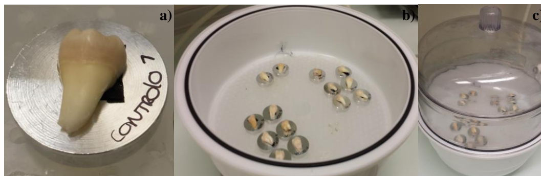
Figura 17 – a) Colocação da amostra na base metálica com recurso a fita condutora; b) e c) Colocação das amostras em vácuo
