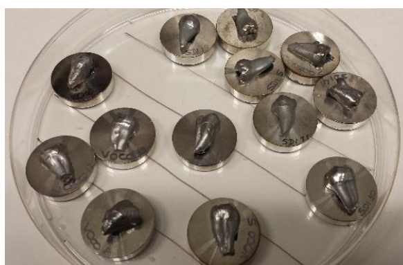
Figura 18 – Amostras após sofrerem metalização
