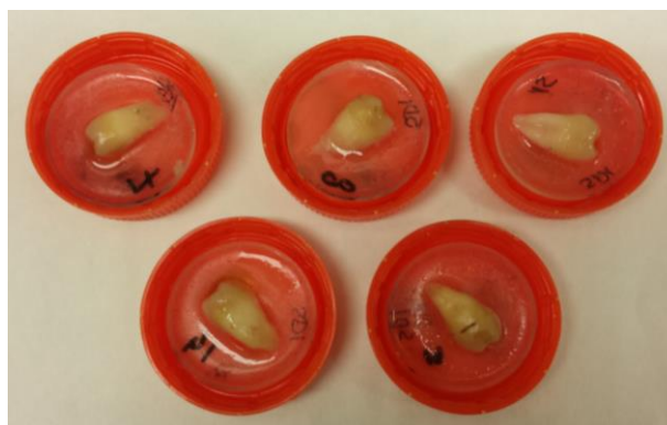
Figura 10 – Confeção da inclusão das amostras em resina époxi
