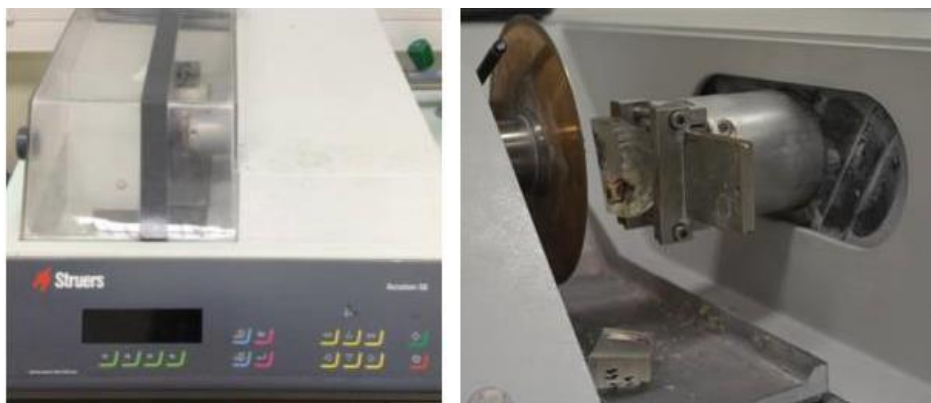
Fig. 6. Micrótopo de tecidos duros – Accutom 50 (Struers, Ballerup, Dinamarca) e corte de amostras
