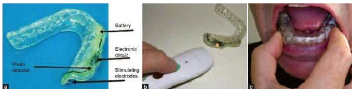
Figura 14 - Neuroelectroestimulador salivar de segunda geração. (a) O estimulador eléctrico em miniatura é incorporado no aparelho removível; (b) O estimulador eléctrico é controlado por um controlo remoto a infravermelhos; (c) Assenta na arcada inferior e é colocado e removido pelo paciente (adaptado de Sarapur & Shilpashree, 2012).
