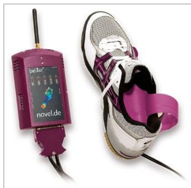
Figura 11. Sistema de aquisição da distribuição da pressão Pedar da Novel.
