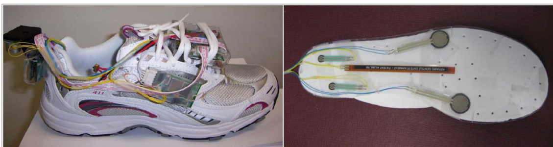
Figura 9. Vista exterior do Sapato Inteligente e da palmilha.
