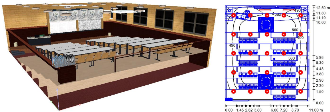
Figura 2. 7 Simulação da iluminação do auditório
