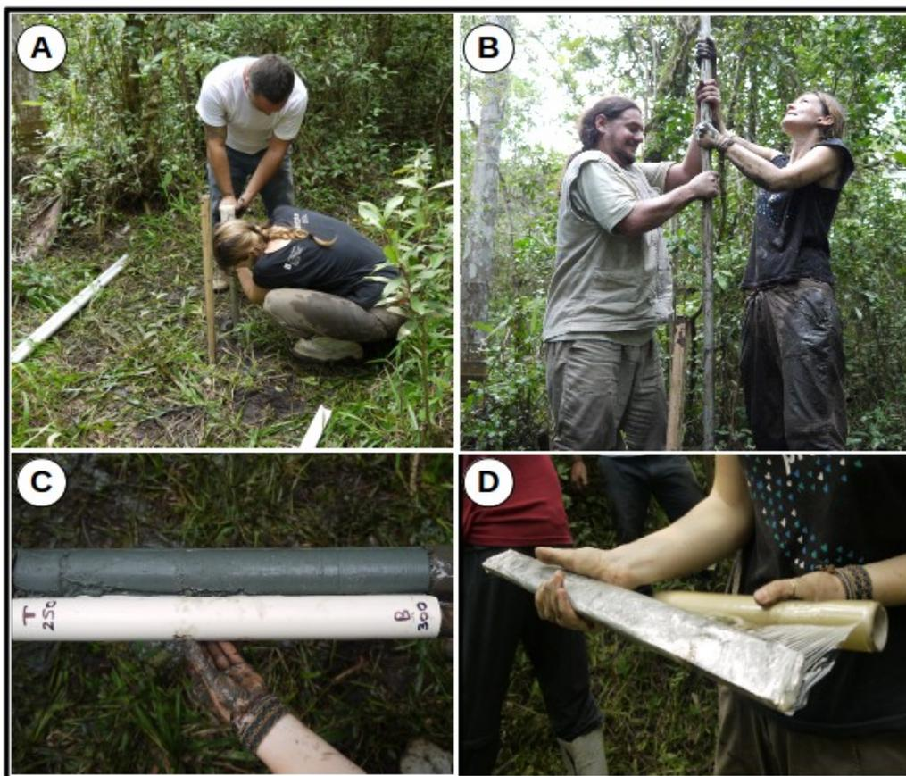
Fig. 24: imagens dos diferentes momentos da coleta do testemunho, sendo A e B a extração da coluna sedimentar; C, o momento de colocar o sedimento nos canos de pvc marcados e tomar anotações sobre as características do material; D, embalagem e armazenamento prévio ao transporte.
