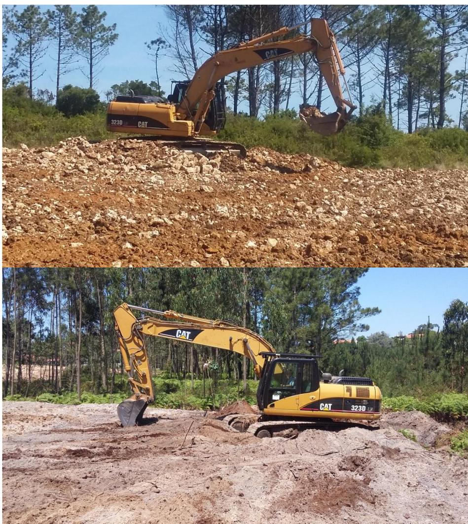
Fig. 5 - Máquina giratória de rastos Caterpillar, modelo 323D, com potência de 140 Hp.
