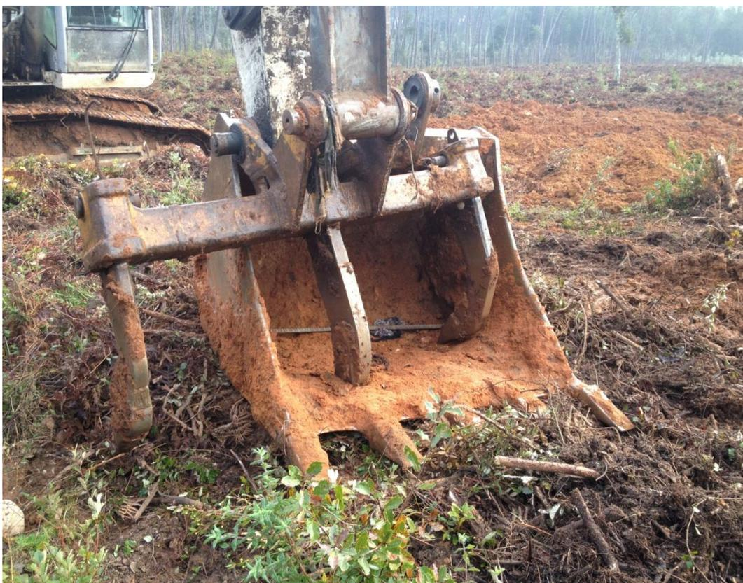
Fig. 4 - Ríper de 3 dentes de acoplagem á máquina giratória.
