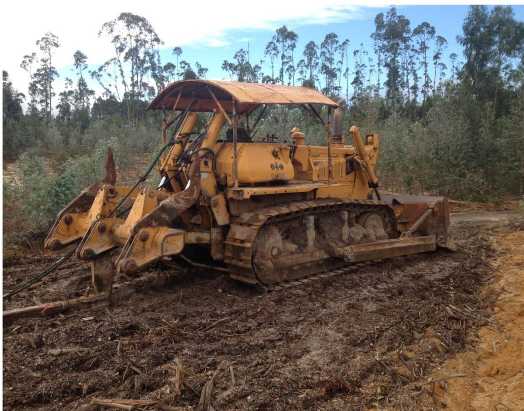
Fig. 2 - Bulldozer de lagartas Komatsu, 228 Hp, equipado com 2 dentes de ríper.
