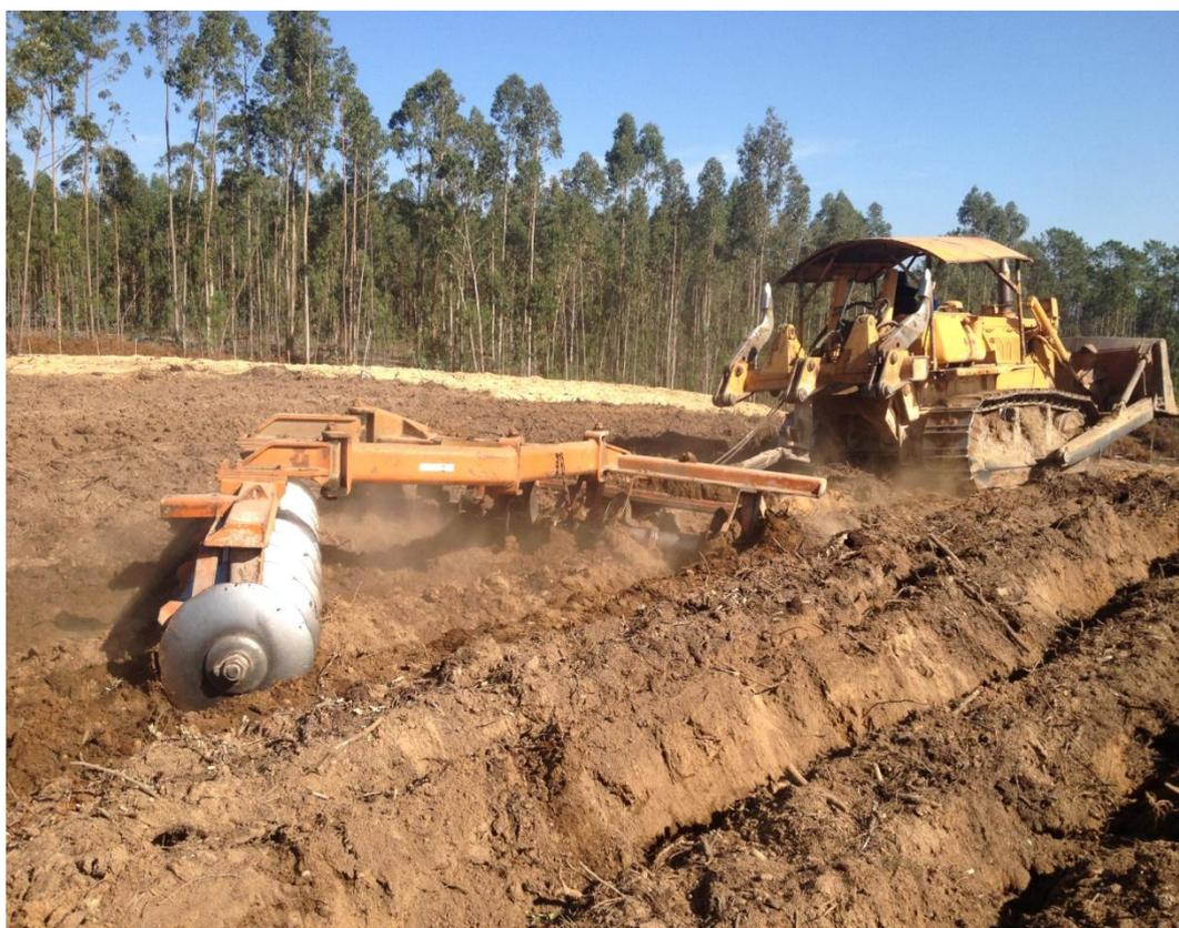
Fig. 1 - Bulldozer de lagartas Komatsu, 228 Hp, com grade de discos off set acoplada.
