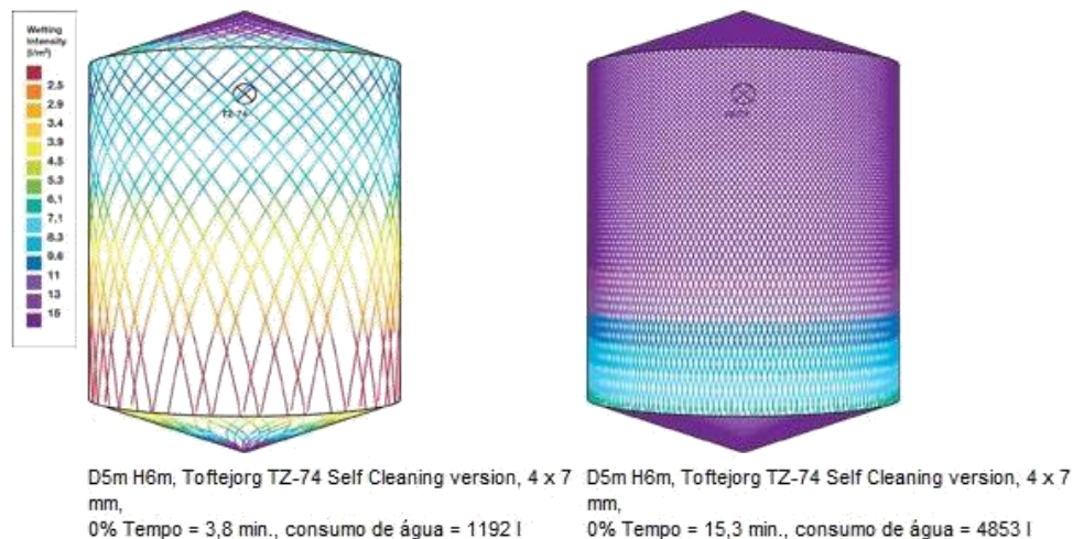
Figura 5-11 Simulação da intensidade de humidade no software TRAX pela empresa Alfa Laval.
