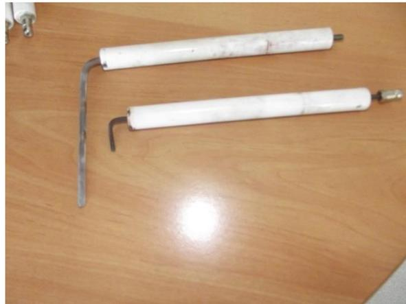
**Figura 30: Eléctrodos usados**
