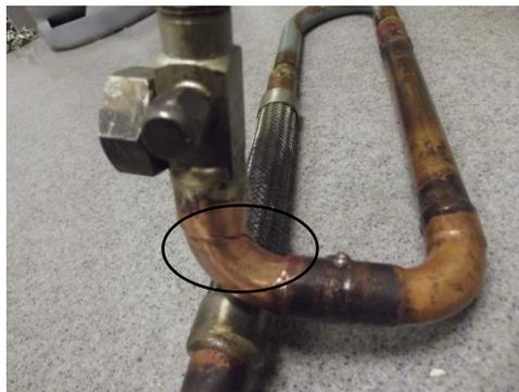
**Figura 72: Tubo fissurado**
