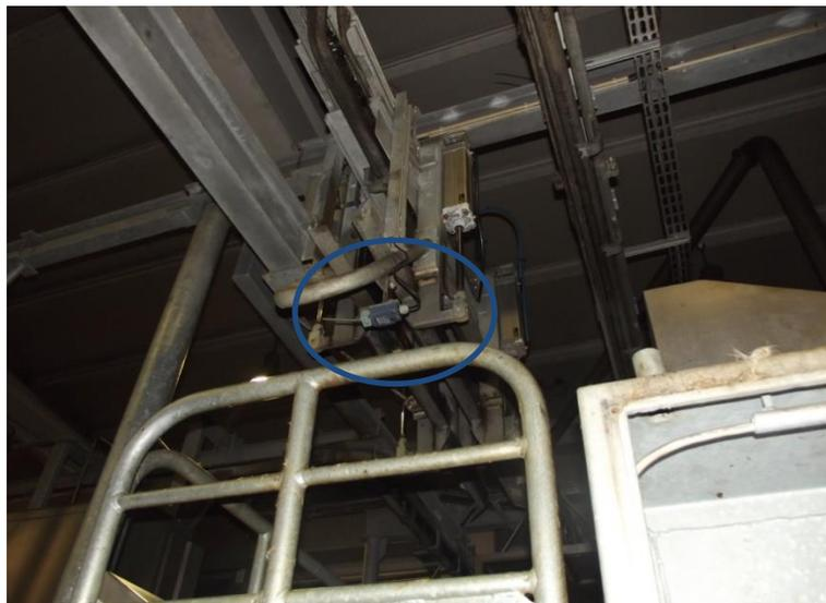
**Figura 63: Sistema de segurança de descarga de suínos**
