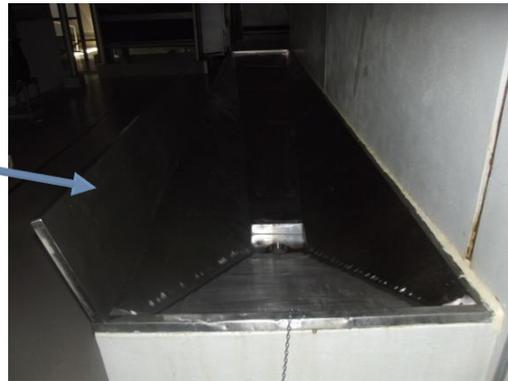
**Figura 55: Sistema de sucção de sangue alimentar**
