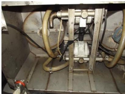
**Figura 56: Desmontagem de Sistema de sucção de sangue alimentar para revisão**
