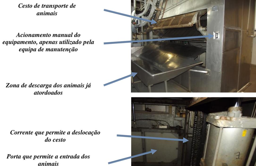
**Figura 51: Equipamento Insensibilização por Co<sub>2</sub>**
