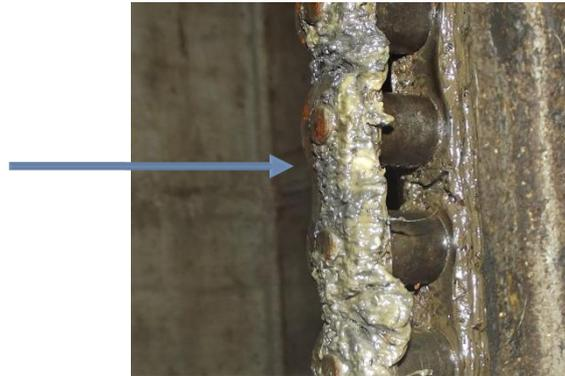
**Figura 52: Componentes com corrosão**
