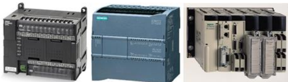
Figura 2.1: Exemplos de autômatos das marcas Omron (CP1L), Siemens (S7 – 1200) e Schneider ( Modicon Premium ), da esquerda para a direita.
