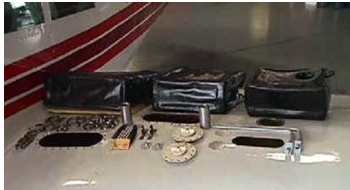
Figura 5 – Tanques de Combustível Flexíveis (27)
