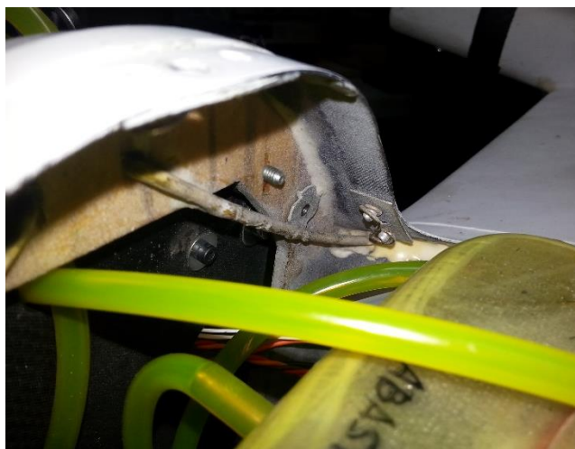
Figura 23 – Detalhe da conexão para abastecimento de combustível
