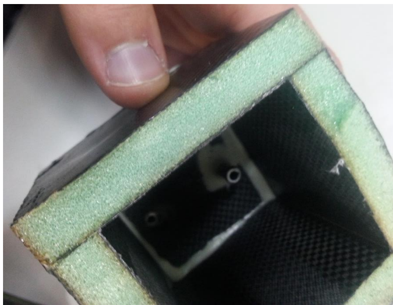
Figura 40 – Depósito seccionado para inspeção visual após o término da experiência
