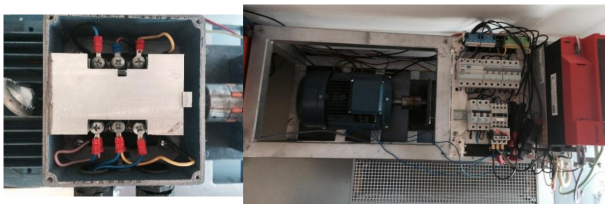
Figura 70 – InSwitch instalado na caixa de terminais do motor e bancada de testes, respetivamente.
