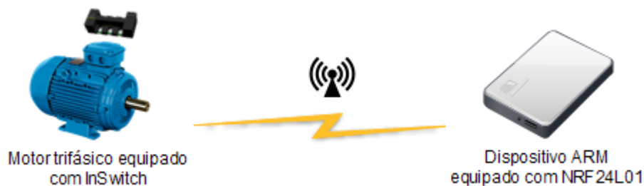
Figura 52 – Parte da rede de monitorização – comunicação rádio frequência.
