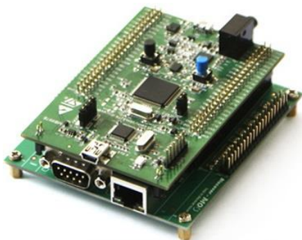
Figura 49 – DevKit407, conjunto das placas STM32F4DISCOVERY e STM32F4DIS-BB .
