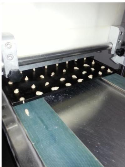
**Figura 6** - Máquina depositadora usada no 1º ensaio industrial.
