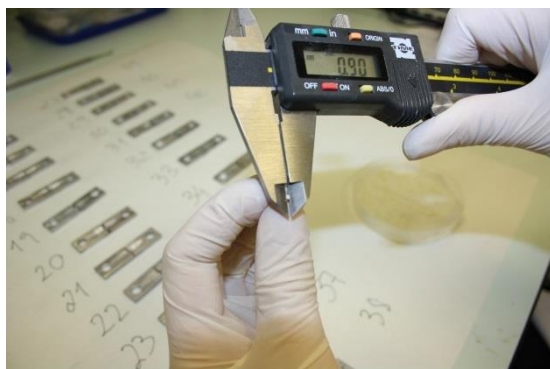
Figura 21 - Medição de um palito, na zona da interface esmalte/resina, no sentido x e y, com uma craveira digital.
