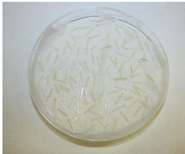
Figura 20 - Palitos de esmalte e resina composta
