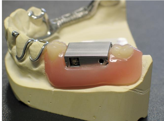
Figura 1. Dispositivo interdental implantável, protótipo “IntelliDrug”(Scholz et al. , 2008).
