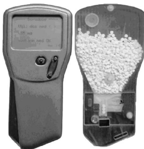
Figura 4. Dispositivo eletrónico para a dispensa de minicomprimidos (Bredenberg et al. , 2003).
