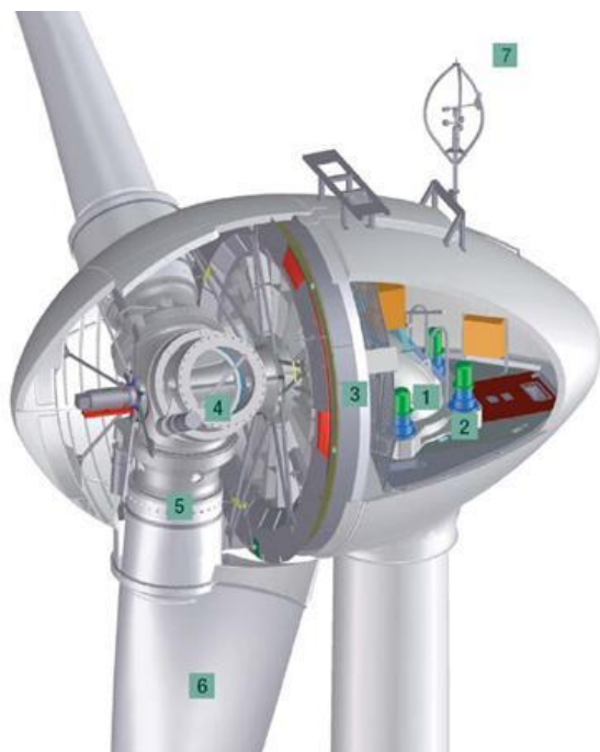
Figura 8 - Aerogerador sem caixa multiplicadora (10)
